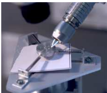
(a) micropince piézoélectrique à quatre degrés de liberté
