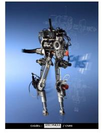
consignes. Pour les tests expérimentaux la commande a été dégradée pour aboutir à de simple régulateur PD indépendant sur chaque axe. Six pas de course ont été réalisés, ce résultat montre que Rabbit est capable de courir mais la commande doit être améliorée pour aboutir à une course sur une longue distance.
