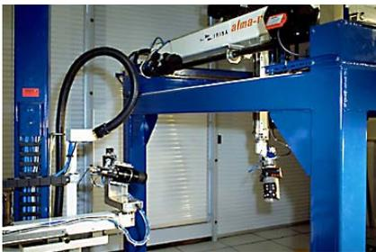
afma Robots, l'un de structure cartésienne à six degrés de liberté, l'autre de structure cylindrique à quatre degrés de liberté. Ces deux robots sont chacun équipés d'une caméra embarquée sur leur effecteur et de cartes de numérisation d'images.
